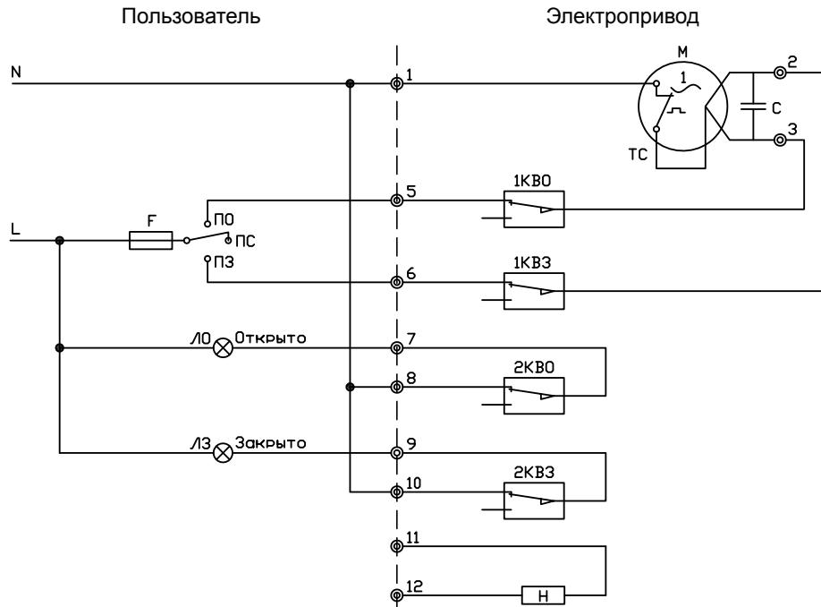
Рис. За. Принципиальная электрическая схема подключения электропривода ГЗ-ОФ(К) к сети 220 В, 50 Гц.
