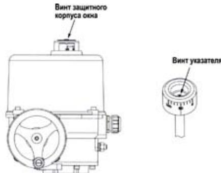
Для удобства считывания информации указатель положения и защитный корпус окон могут регулироваться при помощи винтов крепления.
